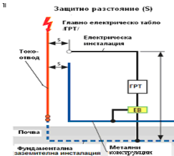
Фиг. 16. Разстояние на разделяне /защитно разстояние/ (S)
