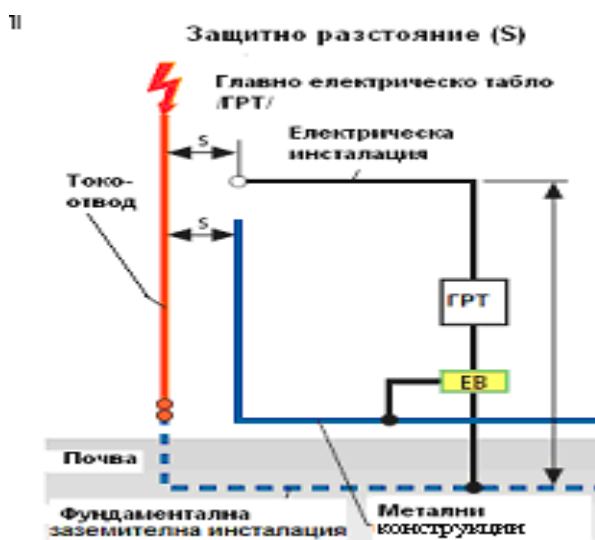
Фиг. 16. Разстояние на разделяне /защитно разстояние/ (S)
